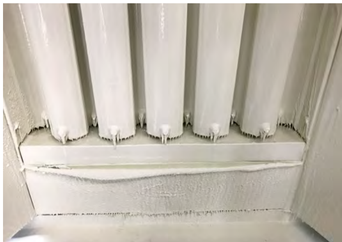
Lacke, die nicht so schnell oder nur durch Nachbehandlung trocknen, fließen langsam nach unten in die Auffangwanne. Quelle (vier Bilder): Haas
