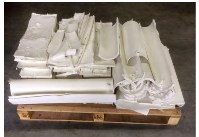
Der getrocknete Lack wird von den Lamellen abgezogen und entsorgt. Damit reduzieren sich 200 kg Overspray auf ca. 0,3 m 3 reine Lackreste.
