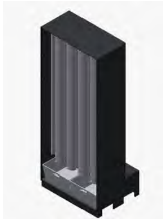
Das Modul besteht aus drei Komponenten: dem aus Kunststofflamellen bestehenden Vorabscheider, den nachgeschalteten Filterkassetten und einer Auffangwanne.
